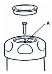
پس از تنظیم فشار مورد نظر می توانید کپ رنگی بالایی ولوم تنظیم را از محل خود خارج نموده و پینی را که داخل آن وجود دارد بر روی سوراخ (A) کف ولوم قرار دهید تا از چرخش و تغییر ناخواسته فشار خروجی جلوگیری بعمل آورد ، سپس می توانید کپ (درپوش رنگی) را دوباره سر جای خود قرار دهید.
