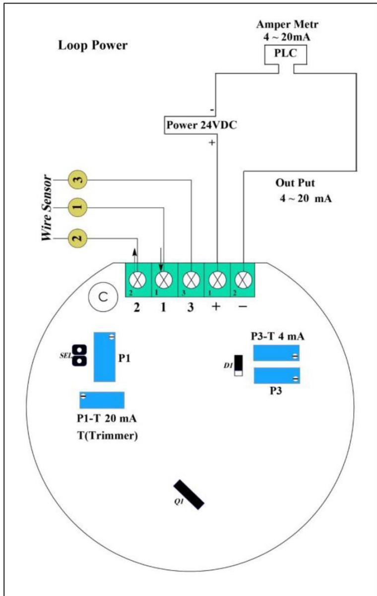
سیمهای خروجی از داخل بدنه اصلی ترانسمیتر به کیت گرد و شماره های ۲،۱،۳ متصل شده است. در صورت نیاز به تعویض کیت گرد توجه شود سیمهای به درستی به شماره های مربوطه وصل شود . پتانسیمتر P1، P1-T جهت تنظیم دقیقتر خروجی 20mA (حد بالا) و پتانسیمتر P3 ، جهت تنظیم دقیقتر خروجی (حد پایین) بکار می رود.
